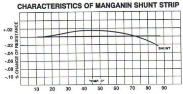
TEMPERATURE COEFFICIENT OF RESISTANCE ±.000015 BETWEEN 40 - 60°C.
